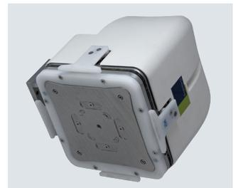
Pour saisir le wafer par le haut, une combinaison de pression négative et d'ultrasons est utilisée. La pression négative assure l'attraction du wafer, tandis que les ultrasons avec leur effet répulsif maintiennent la pièce à distance. Ainsi, aucun point de contact ne peut se produire entre le wafer solaire et la pince, ce qui garantit une manipulation en douceur.
