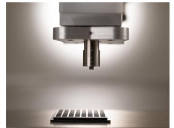
Grâce à une combinaison de pression négative et d'ultrasons, des forces d'attraction et de répulsion agissent simultanément sur la pièce, la maintenant ainsi à distance même lors de la prise par le haut. Par conséquent, aucune contamination ou micro-rayure ne peut se produire sur la petite pièce.
